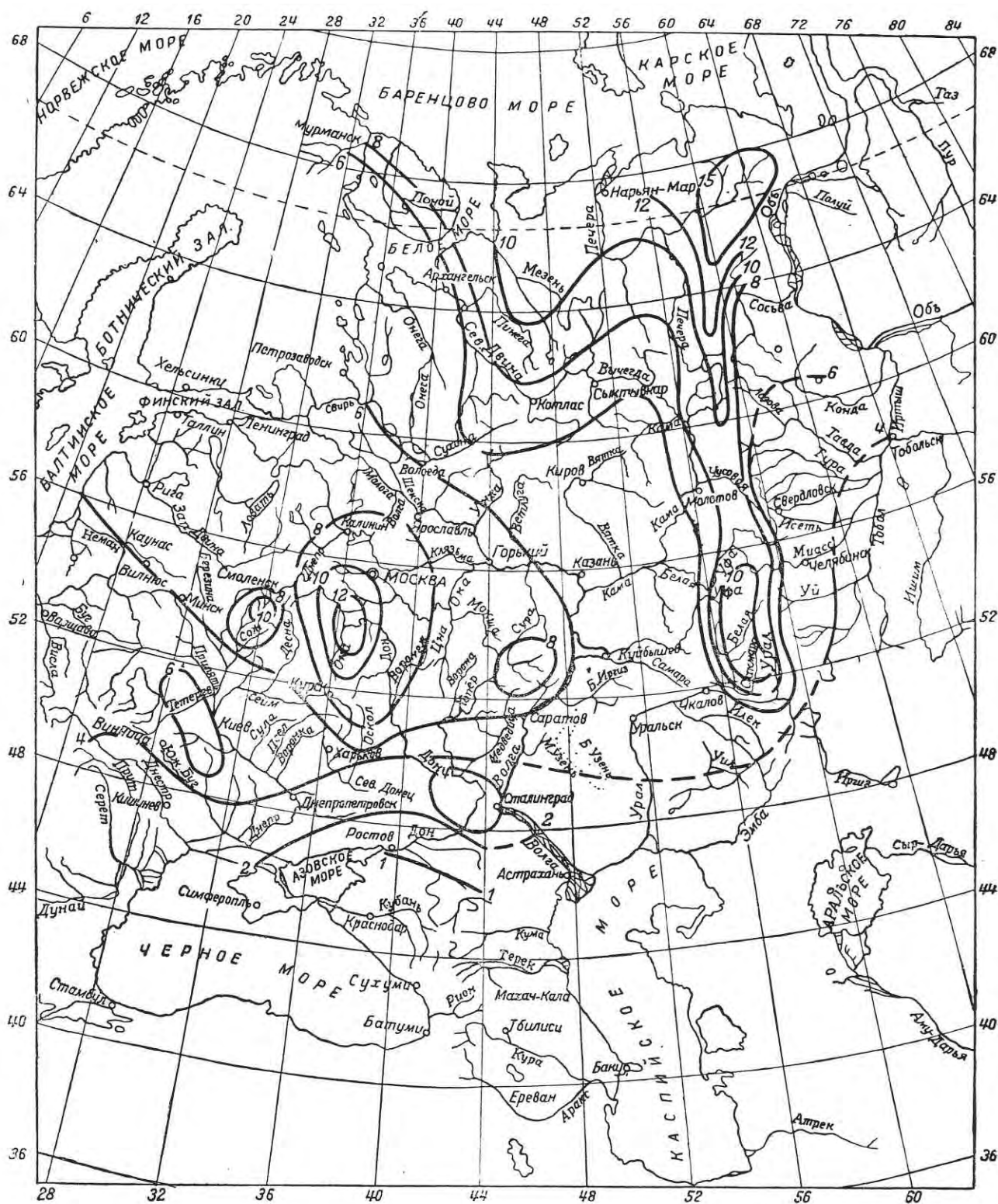
Фиг. 13—8. Карта изолиний параметра A_p в мм/час по формуле Д. Л. Соколовского для определения максимальных расходов талых вод (1% обеспеченности)
