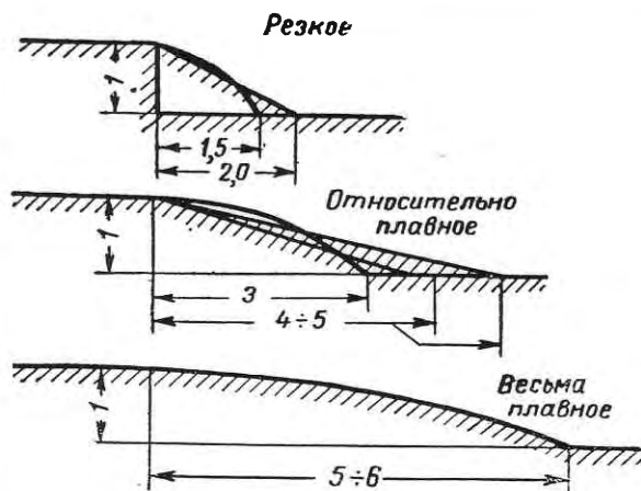
Фиг. 2—148. Типы сопряжения трубы с нижним бьефом в вертикальной плоскости
