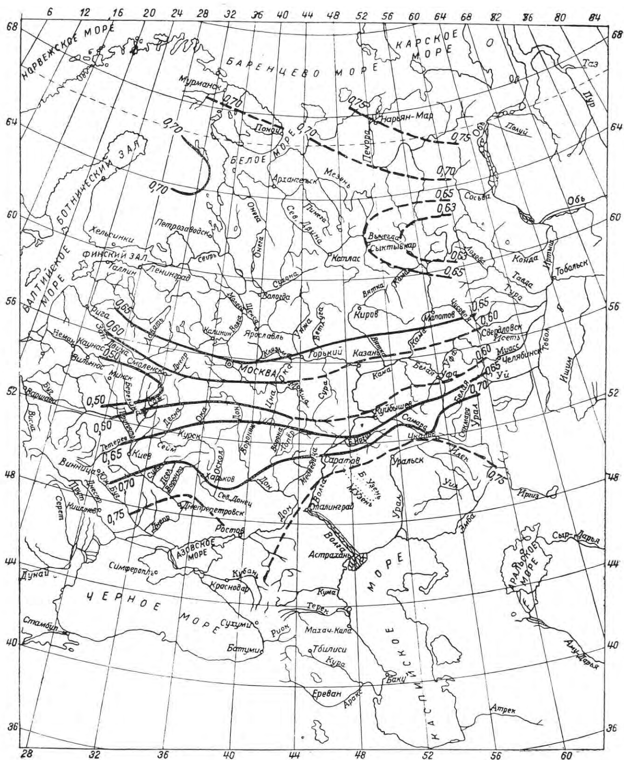
Фиг. 13—17. Схематическая карта параметра f_z к формуле Н. Д. Антонова для определения зимних минимальных расходов
