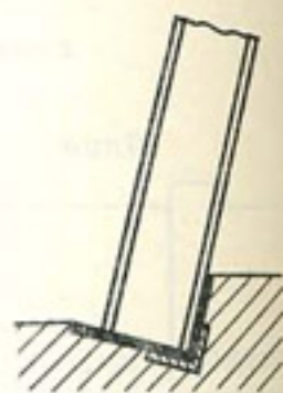
Рис. 7—10. Нижняя опора трубчатых спиц.
