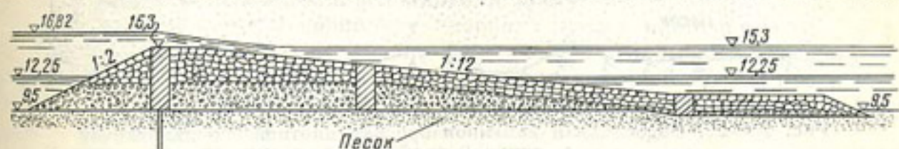
Рис. 16—20. Водосливная плотина распластанного профиля.
