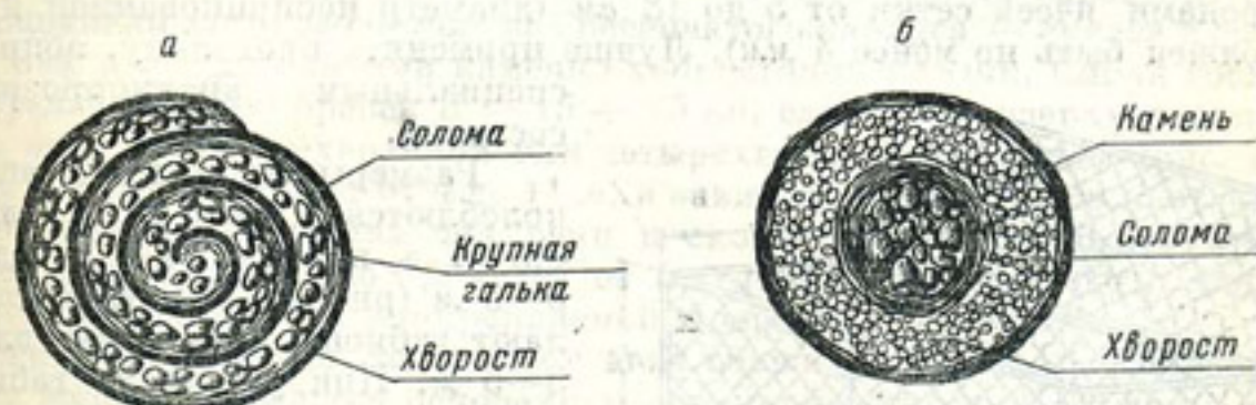
Рис. 24—2. Сечения карабуры (а) и тяжелой фашины (б).
