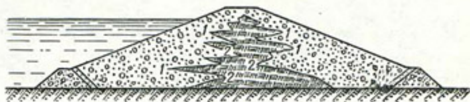
Рис. 13—12. Намывное ядро плотины: 1 — языки; 2 — карманы.
