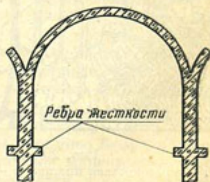
Рис. 20—14. План контрфорса с ребрами жесткости.
