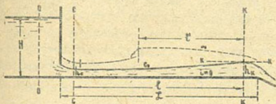
Рис. I. Формы кривых свободной поверхности потока в лотке за щитовым отверстием перед перепадом.
